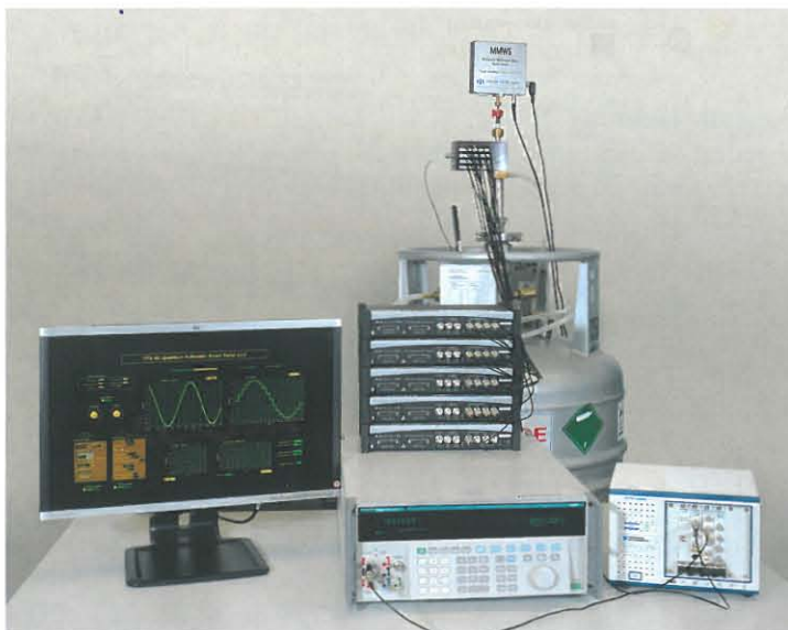
Ein kommerzielles Präzisionsmessgerät (Bildmitte, unten) wird durch das AC-Quantenvoltmeter im Wechselspannungsmodus kalibriert.
