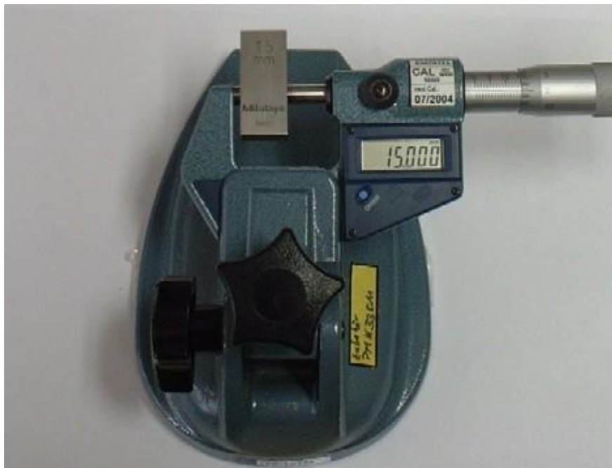
Bild L.V.1 Kalibrierung einer Bügelmessschraube
